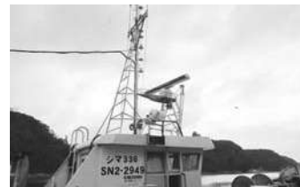
レーダーシステム空中線装置
